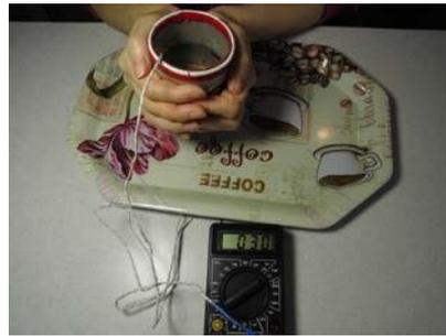
измерили температуру на поверхности каждой из них с помощью прибора, который называется контактным термометром (рисунок 1). Результат измерений показан в таблице ниже.
